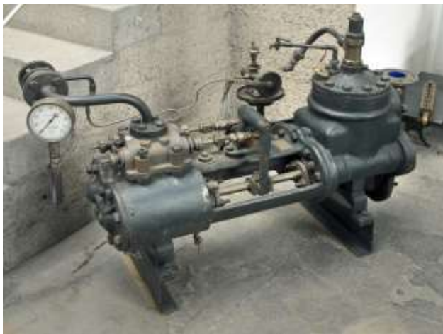
Eine Duplex-Dampfmaschine speiste den Dampfkessel der Bettfedernfabrik von Werner & Ehlers. Diese und eine weitere Pumpe sind nicht erhalten.
