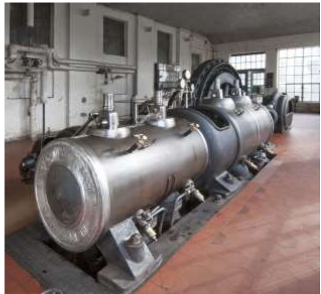
Restaurierte Tandem-Verbundmaschine mit Schwungradgenerator, Leistung 200 PS, Dampfdruck 12 kg/cm 2 , Drehzahl 150 U/Min, Hersteller K. und Th. Möller GmbH, Brackwede in Westfalen
