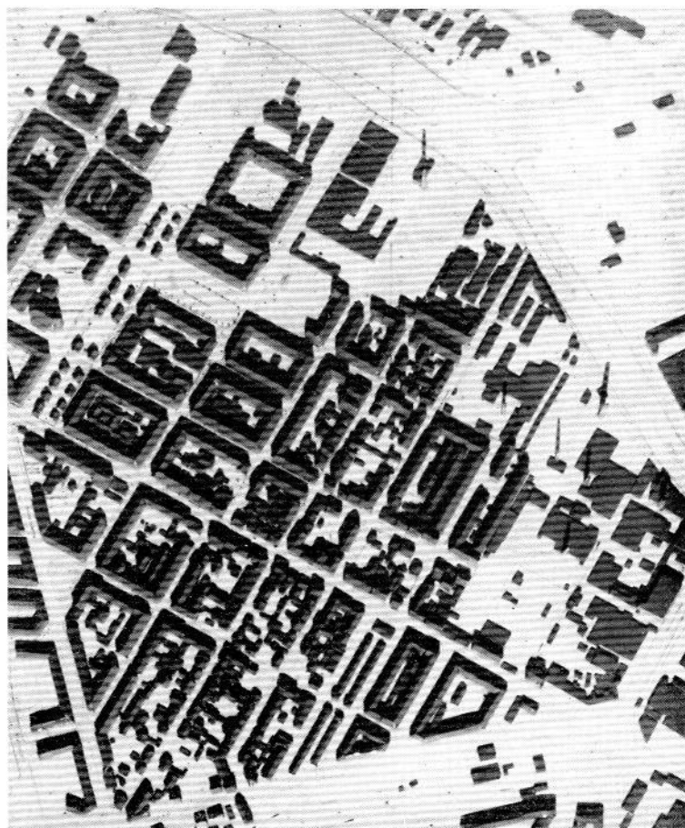
KII/4b Besonnungsmessung am Arbeitsmodell, durchgeführt mit Besonnungsmesser nach Oberbaurat Strohmeier, Hamburg. 21. März, 23. September, 12.00 Uhr.
